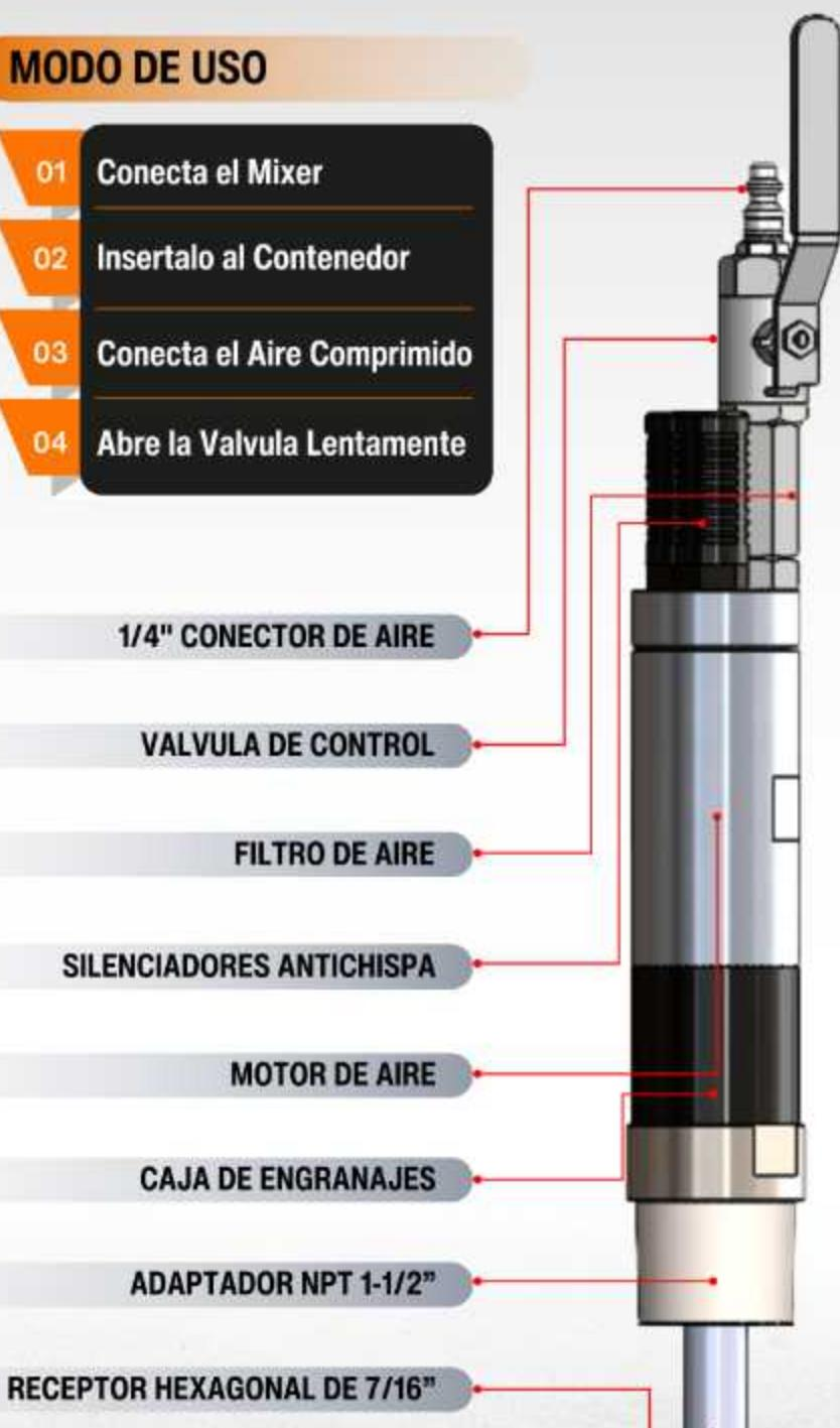
El rendimiento óptimo del Even Mix® Air Drive se logra cuando se suministra con aire limpio regulado entre 40 PSI y 90 PSI. La presión no debe exceder los 140 PSI.
